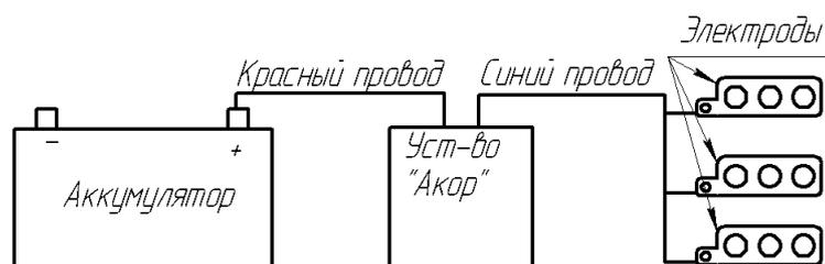
Электроды устанавливаются при помощи «холодной сварки» (вид эпоксидного клея) на места, где коррозия наиболее вероятна на расстоянии 40 ... 80 см друг от друга. О замыкании электродов на корпус сигнализирует встроенный индикатор красного цвета. В нормальном режиме работы индикатор светиться не должен.
